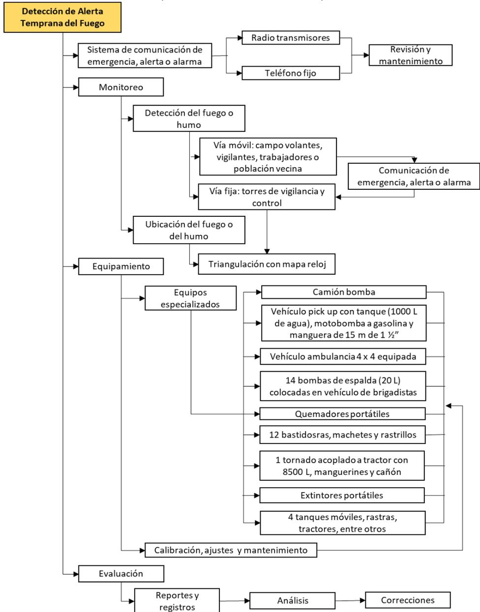
Figura 13. Esquema simplificado de detección temprana del fuego
