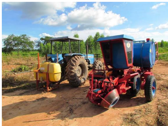
Foto 31. Equipo de aspersión (izquierda) y equipo múltiple de siembra (derecha).
