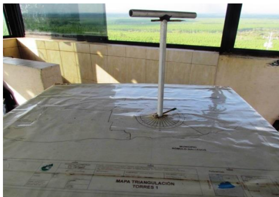
Foto 38. Mapa de triangulación de la Torre 1 para ubicar el fuego o el humo.
