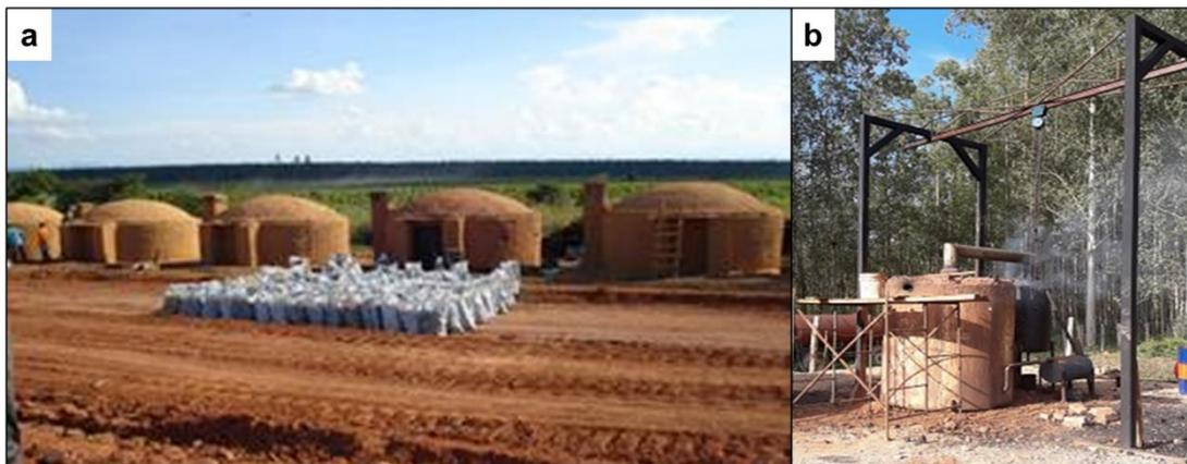
Figura 13. Horno tipo “Rabo quente” o Colmena (a). Horno de metal portátil en experimentación (b). DEFORSA.
