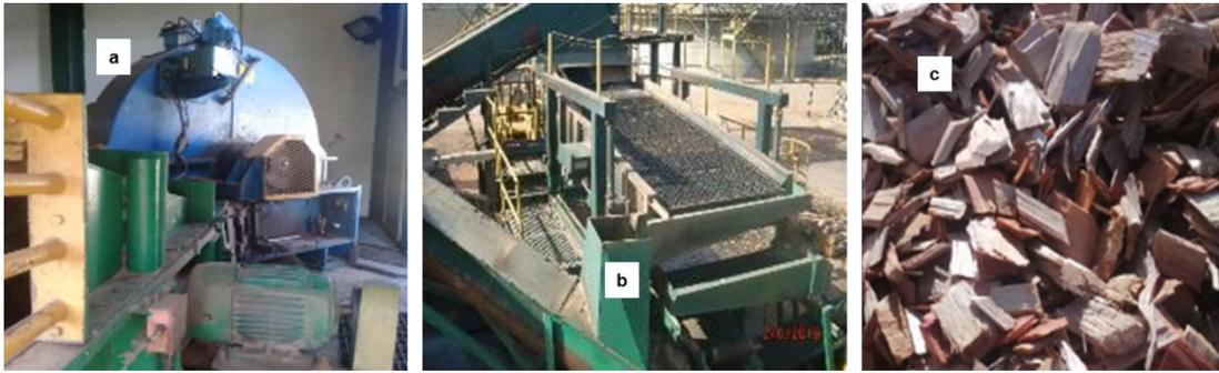
Figura 28. Equipo picador (a). Equipo para tamizar (b). Astillas de madera de *Corymbia*.
