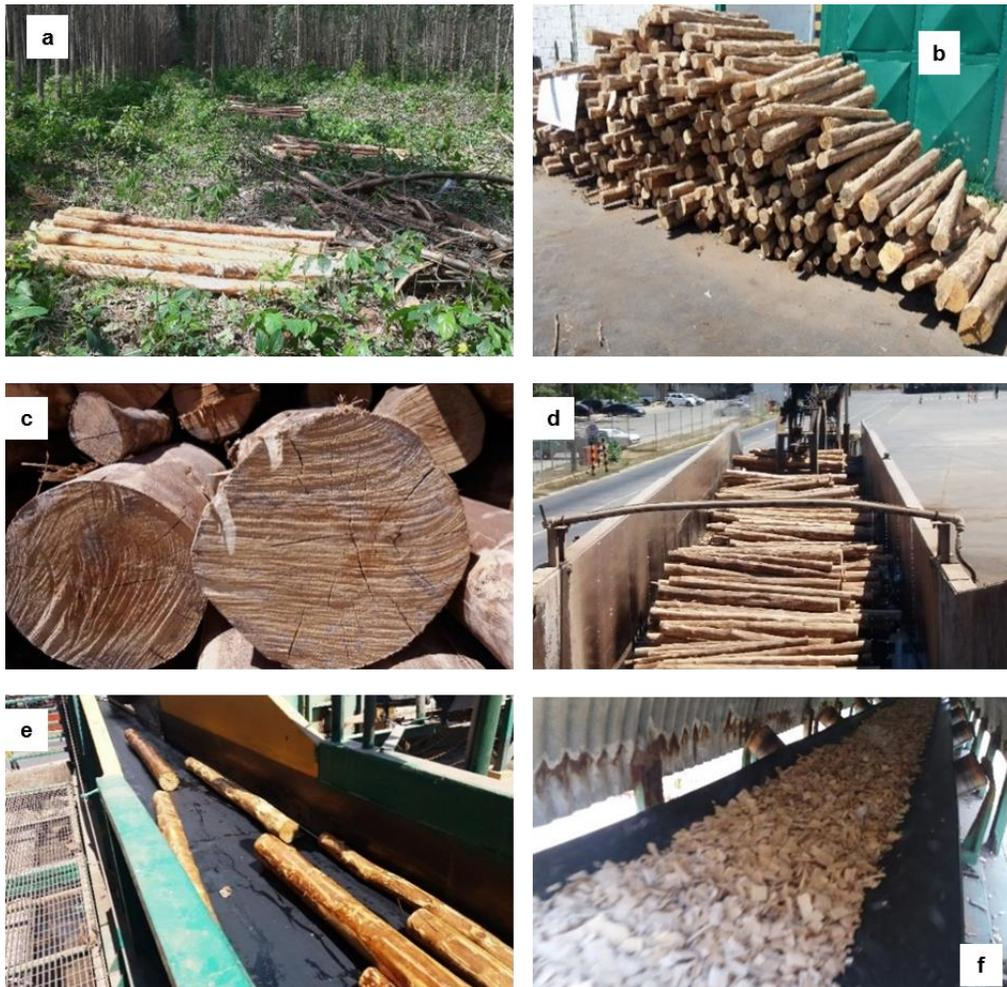
Figura 29. Cosecha (a). Apilado en planta (b). Detalle de las rolas (c). Lavado de la madera y proceso de limpieza (d). Madera en la correa del picador (e). Transportador de astillas (f).
